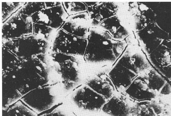
Abb. 8.7. REM-Aufnahme einer mit Kieselsäure verschmutzten Membran
